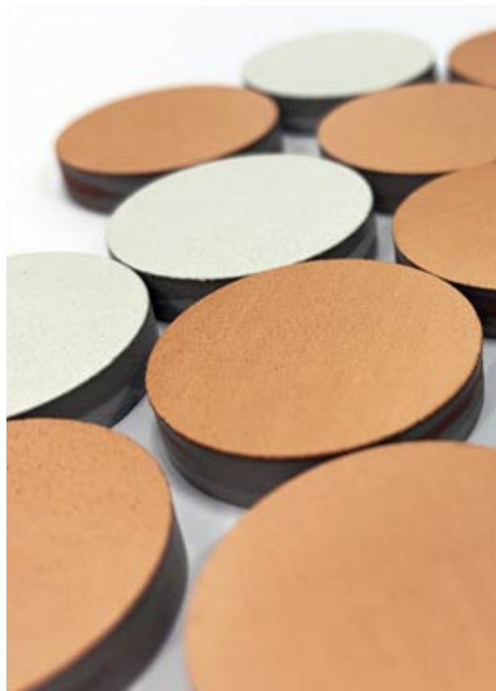
Figuur 3 Proefstukken, gecoat met koper en aluminium, voor het bepalen van de hechtsterkte (© IMPACT)
