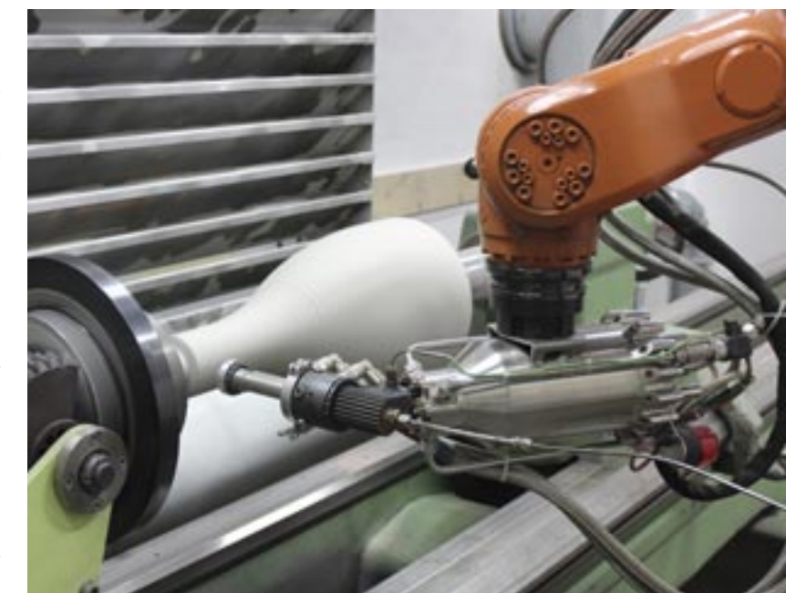
Figuur 2 Cold Spray Additive Manufacturing van een mondstuk van een raket (© IMPACT)
