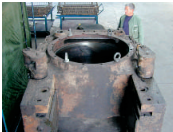
Figuur 3. Aanlevervorm van een te repareren inbouwstuk
