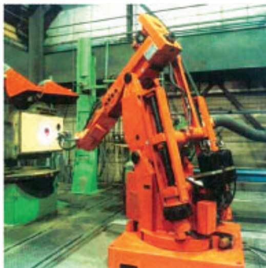
Figuur 4. Robotmatig opspuiten van de zijvlakken (slijtplaatvlakken)
