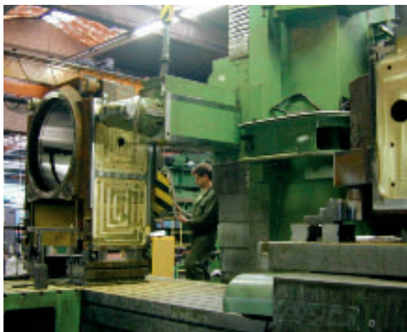
Figuur 6. Het frezen van de opgespoten slijtplaatvlakken
